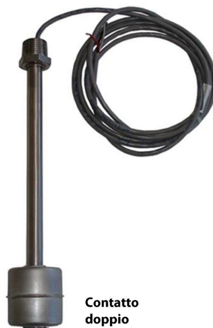
Interruttore di livello reed miniaturizzato o standard a galleggiante serie CPTL07 realizzato con uno o due contatti, disponibile con contatto SEMPLICE, DEVIATO o a DOPPIA POSIZIONE. Invertendo la posizione del galleggiante è possibile cambiare la funzione del contatto da normalmente aperto a normalmente chiuso.
