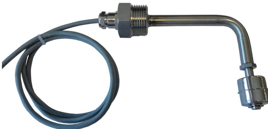
Interruttore di livello reed miniaturizzato a galleggiante a 90° serie CPTL07 con galleggiante. Invertendo la posizione del galleggiante è possibile cambiare la funzione del contatto da normalmente aperto a normalmente chiuso.
